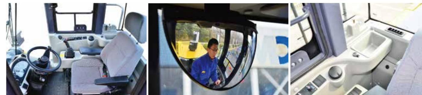
Полно покрывная изящная декорация, кабина, капот применяет способ обработки демпфированием для понижения шума, шум может понижаться на 6 дБ и выше.
