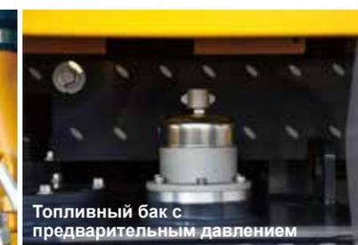
Топливный бак с предварительным давлением
