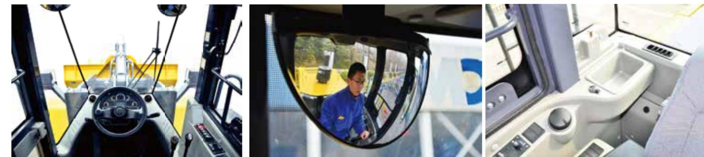
Полно покрывная изящная декорация, кабина, капот применяет способ обработки демпфированием для понижения шума, шум может понижаться на 6 дБ и выше. Шум в кабине соответствует европейскому стандарту, что создает комфортабельную обстановку операции.
