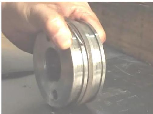
9. Снимите направляющую втулку со штока, затем снимите упорное кольцо и стопорное кольцо направляющей втулки;
