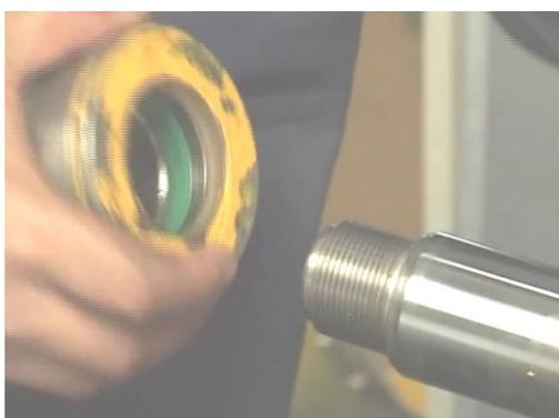
10. Снимите O-образное кольцо и упорное кольцо между направляющей втулкой и корпусом гидроцилиндра с помощью проволочного крючка;
