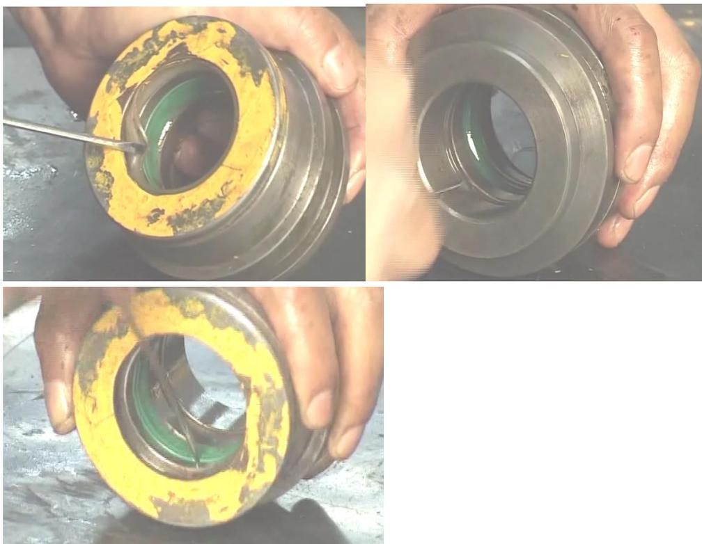
12. Снимите стопорное кольцо шарнирного подшипника с корпуса гидроцилиндра с помощью клещей для внутренних стопорных колец, затем слегка выбейте шарнирный подшипник с помощью медного стержня;
