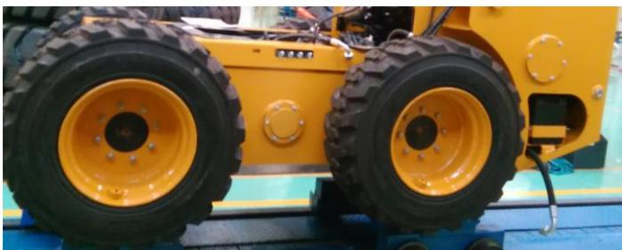
Для монтажа колеса рекомендуется 3 человека. 2 человека поддерживают шины на двух сторонах. 1 человек отвечает за направление монтажного отверстия.
