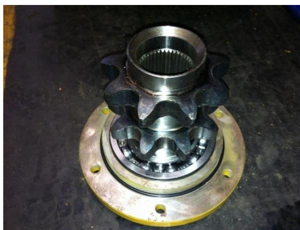
④ Снять болты перекрышки мотора, снять перекрышку мотора, двухрядные звездочки и подшипник;
