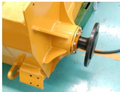
① По методу замены масла звездочки полностью очистить масла звездочки; С помощью домкрата поднять машину на воздух и 4 колеса отходят от земли. Обратить внимание на поддержание стабильности центра тяжести машины, снять крепежные болты обода, снять обод шины;
