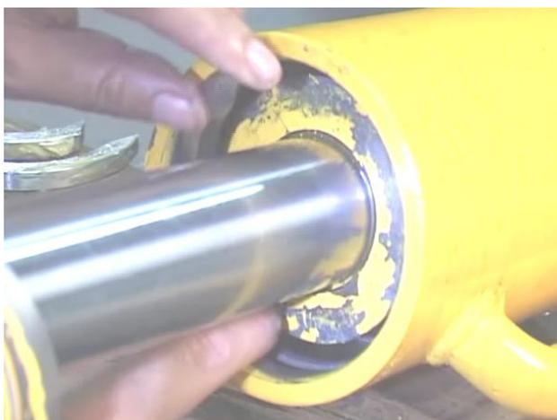
19. Зафиксируйте корпус гидроцилиндра, затем потяните шток с помощью подъемного приспособления, вытяните направляющую втулку, чтобы стопорное кольцо находилось в предельном положении;
