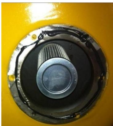
Для предотвращения утечки масла после замены фильтрующего элемента, на контактной поверхности между перекрышкой и масляным баком покрыть герметиком. На резьбе намазывать крепёжный клей с резьбой. Резьбы симметрично крепятся 2-4 раза.
