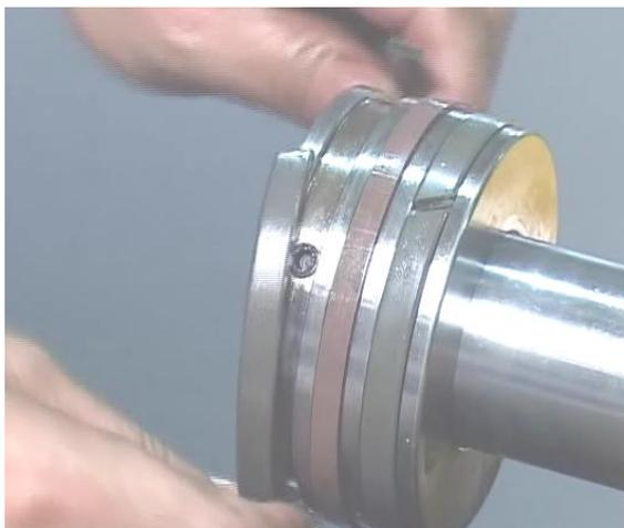
16. Отдельно нанесите умеренное количество гидравлического масла на внутреннюю стенку, поршень, направляющую втулку; затем установите поршень, шток, направляющую втулку в гильзу цилиндра вертикально, не допускается установка поврежденных опорных колец и уплотняющих деталей поршня;
