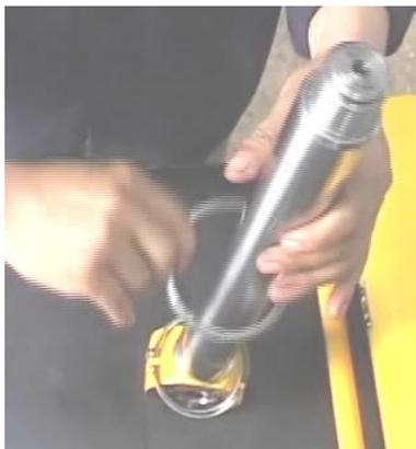
14. Нанесите гидравлическое масло на сопрягаемые поверхности штока и направляющей втулки, наденьте направляющую втулку на шток, избегайте путанице в направлении установки направляющей втулки;
