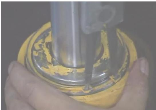
21. Нанесите умеренное количество мази на поверхность отверстия в шарнирном подшипнике на штоке, слегка забейте шарнирный подшипник в отверстие в шарнирном подшипнике на штоке с помощью медного стержня, затем установите стопорное кольцо в кольцевую канавку на шарнирном подшипнике с помощью клещей для внутренних стопорных колец, убедитесь в надлежащей посадке стопорного кольца в канавке.
