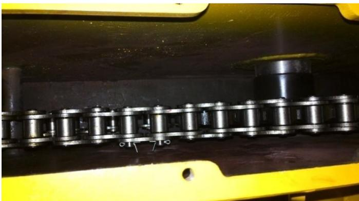
При монтаже цепи установить шплинт на внешней стороне, и разводить шплинты двух цепей.
