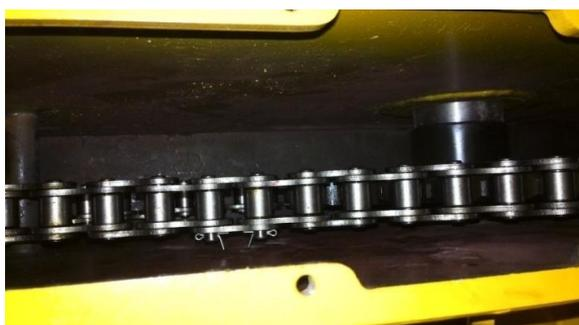
② Снять перекрышку на коробке звездочки, открыть внутреннюю цепь;
