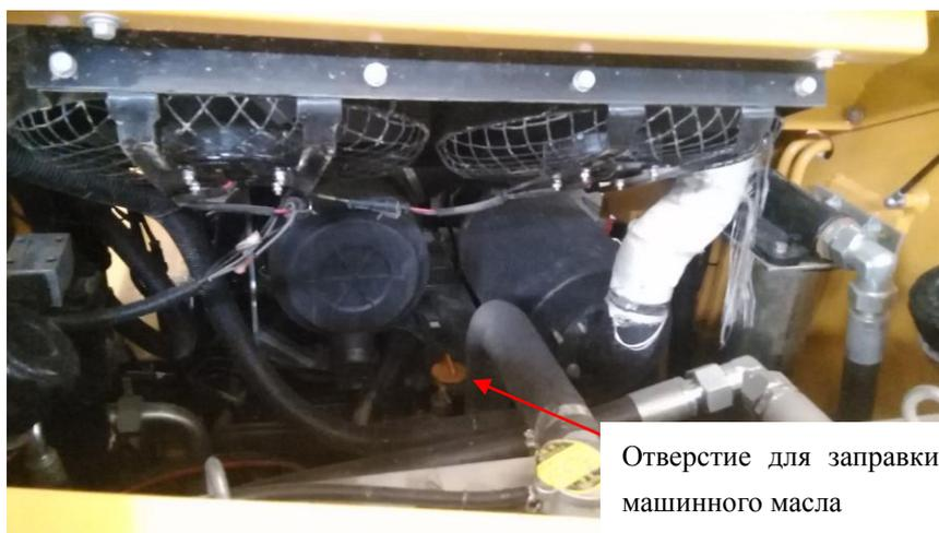
2. Открыть крышку горловины заправки. Добавить машинное масло из отверстия заправки машинным маслом. При добавке следует фильтровать через фильтрующую сетку; Наблюдать градуировку маслоуказателя до достижения требования, потом установить крышку горловины заправки.
