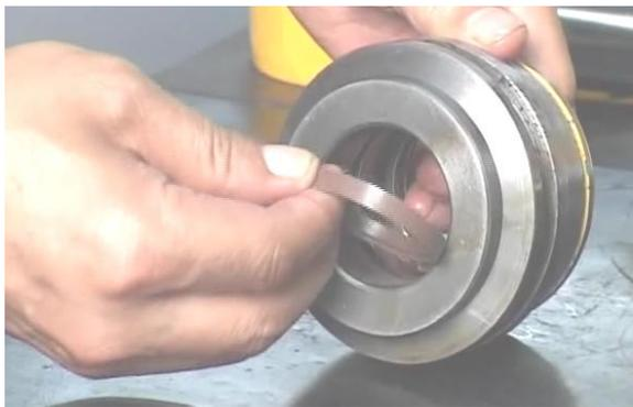
8. Установка уплотнительного кольца КУС: погрузите уплотнительное кольцо КУС в гидравлическое масло при температуре 100°C и подогрейте его около 2 минут, затем установите его в канавку направляющей втулки, дайте губкам направляться к гильзе цилиндра;
