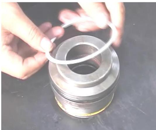
10. Установка пылезащитного кольца: установите пылезащитное кольцо в канавку на внутренней поверхности отверстия направляющей втулки;
