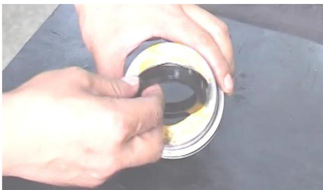
9. Установите O-образное кольцо и упорное кольцо между направляющей втулкой и гильзой цилиндра, не допускается наличие деформации скручивания O-образного кольца, O-образное кольцо должно быть расположено с внутренней стороны упорного кольца, не путайте местами установки;
