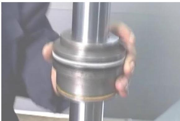
15. Кладите поршень на шток и затяните, установите упорный винт поршня и затяните, затем два опорных кольца на поршень так, чтобы стыки двух опорных колец были расположены под углом 180°;
