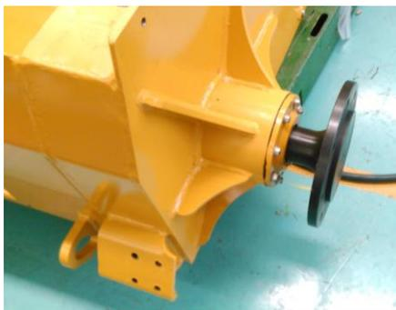
Соединительные болты намазываются клеем для крепления резьбы; Все болты укрепляются 2-4 раза по методу противоположного угла.
