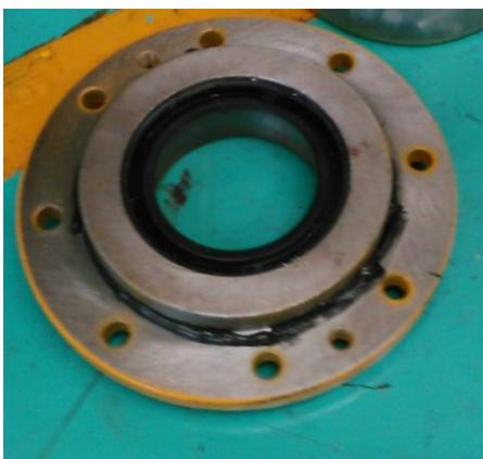
Поверхность прилегания сборки фланцевой и масляной крышек шин должна быть покрыта плоским герметиком.
