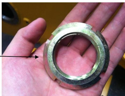
⑤ Снять болты крышки фланца шины на внутренней стороне рамы, снять круглую гайку M45;
