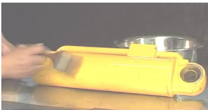
2. Подвиньте шток в двух направлениях, полностью удалите остатки масла из гидроцилиндра;
