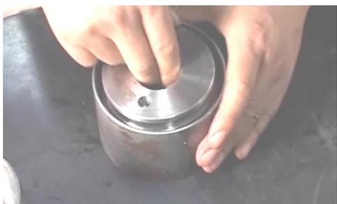
12. Установите O-образное кольцо между поршнем и штоком, не допускается наличие деформации скручивания O-образного кольца;
