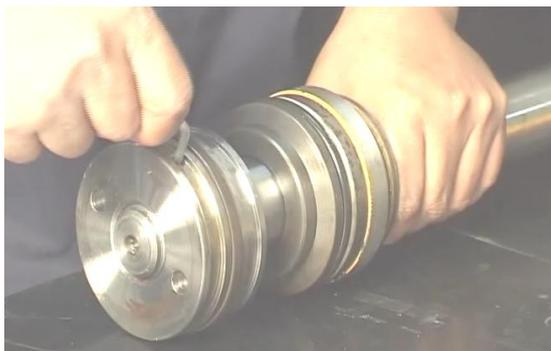
8. Снимите поршень со штока, затем с поршня снимите O-образное уплотнительное кольцо и двухэлементное поршневое уплотнение между поршнем и штоком;
