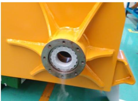
Перед монтажом подшипник должен погружаться в тавоте. Внутренняя полость подшипника должна иметь тавот.
