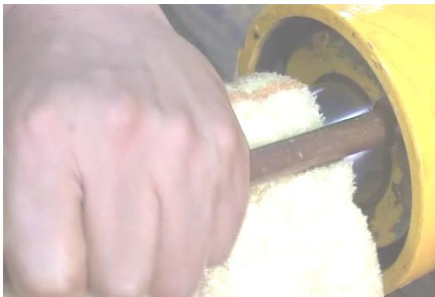
18. Нанесите умеренное количество мази на стопорное кольцо и установите его в кольцевую канавку на гильзе цилиндра;
