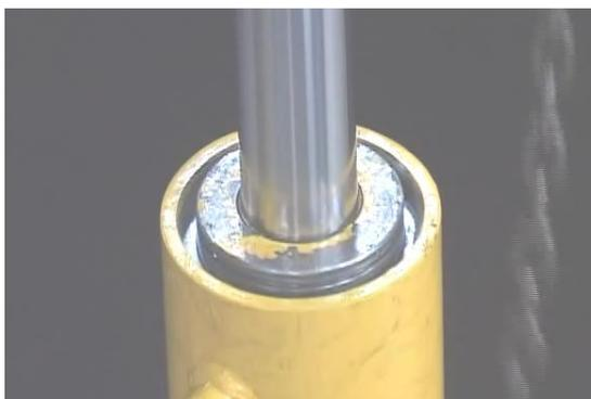
20. Установите упорное кольцо в гильзу цилиндра, затем установите стопорное кольцо в
