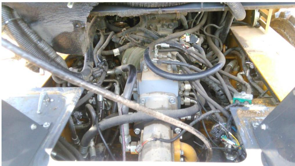
(2) Поднимать кабину водителя для технического обслуживания и ремонта многоходового клапана и трубопровода ходового насоса
