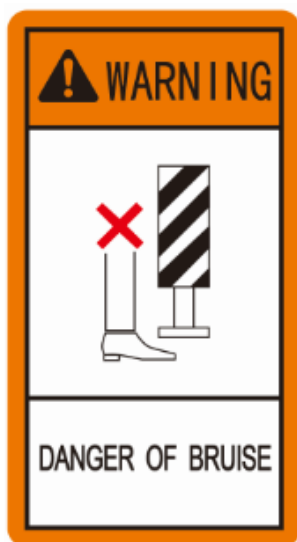
Рис. 1-15 Избежать задира выносными опорами
